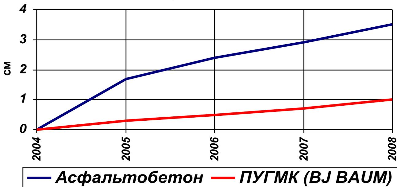
Как видно из графиков, образование колеи в материале «ПУГМК (VJ VAUM)» за 4 года составило 1 см, а в примыкающей зоне асфальтобетона – 3,5 см, т.е. интенсивность образования колеи в «ПУГМК (VJ VAUM)» в 3,5 раза ниже, чем в асфальте.
