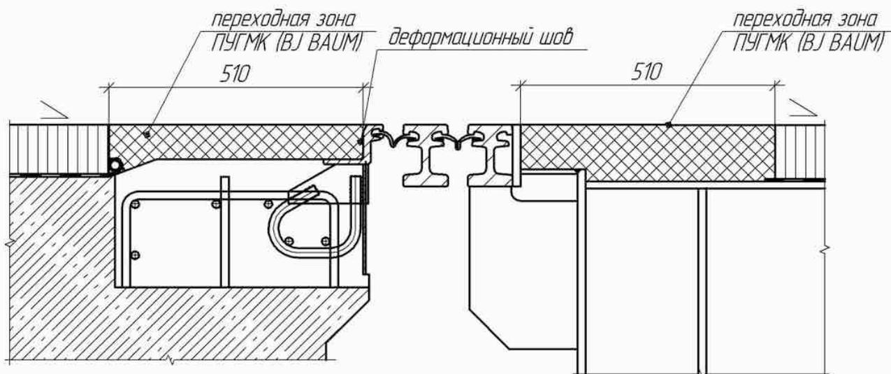
**Конструкция «ПУГМК (ВJ ВАУМ)» для деформационного шва РМ-ДШ-70**
