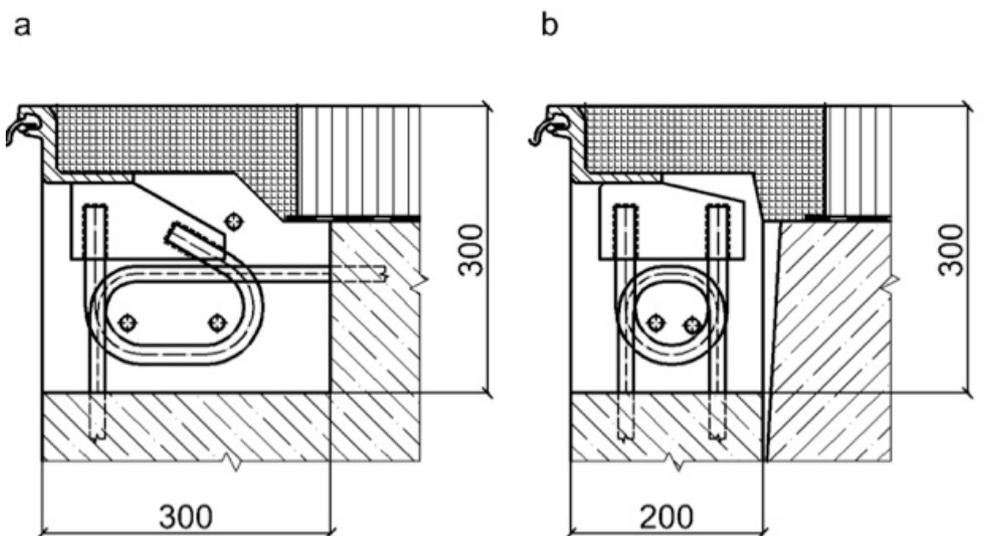
а - Основной анкер для пролетных строений и шкафных стенок.
