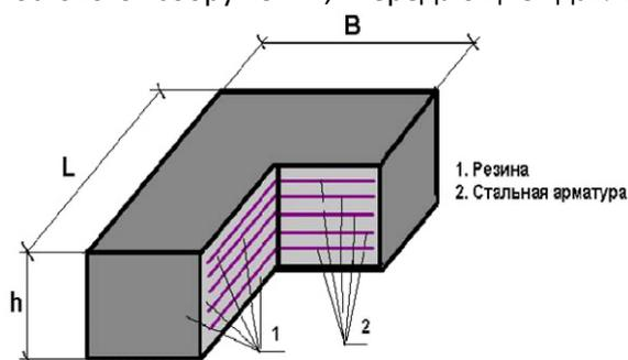
Резины, используемые при изготовлении РОЧ, обладают комплексом свойств, необходимых для долговременной эксплуатации изделия: высокой устойчивостью к механическим нагрузкам (удельная вертикальная нагрузка составляет 15 мПа и выше) и химико-физическим воздействиям.
