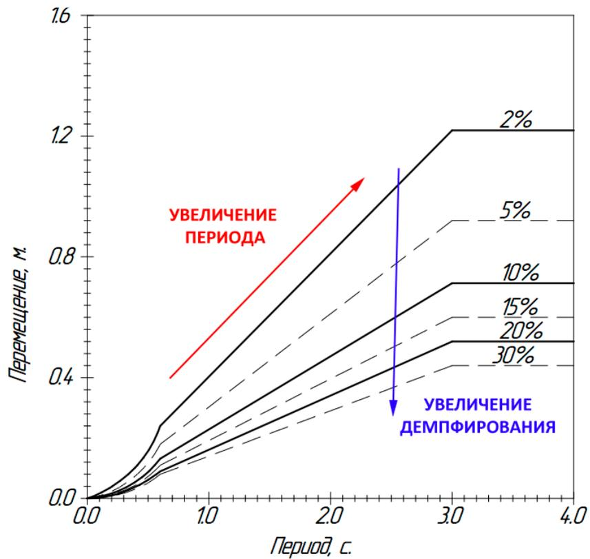
Рис. 4 - Зависимость перемещений от коэффициента демпфирования.
