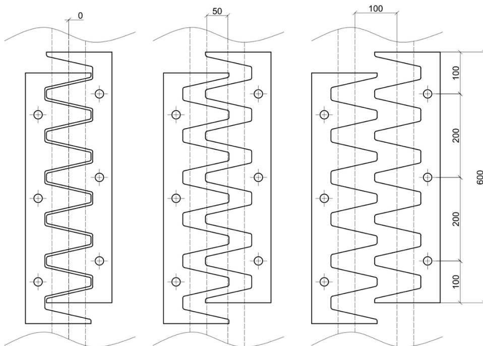
*Пример использования шумопонижающих пластин для деформационных швов*
