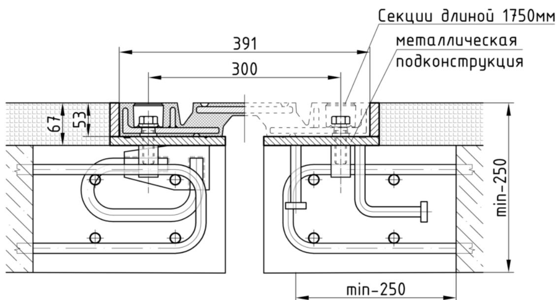
Конструкция деформационного шва РМ ДШ-80 и пример металлической подконструкции для него (на петлевых анкерах и гибких упорах)
