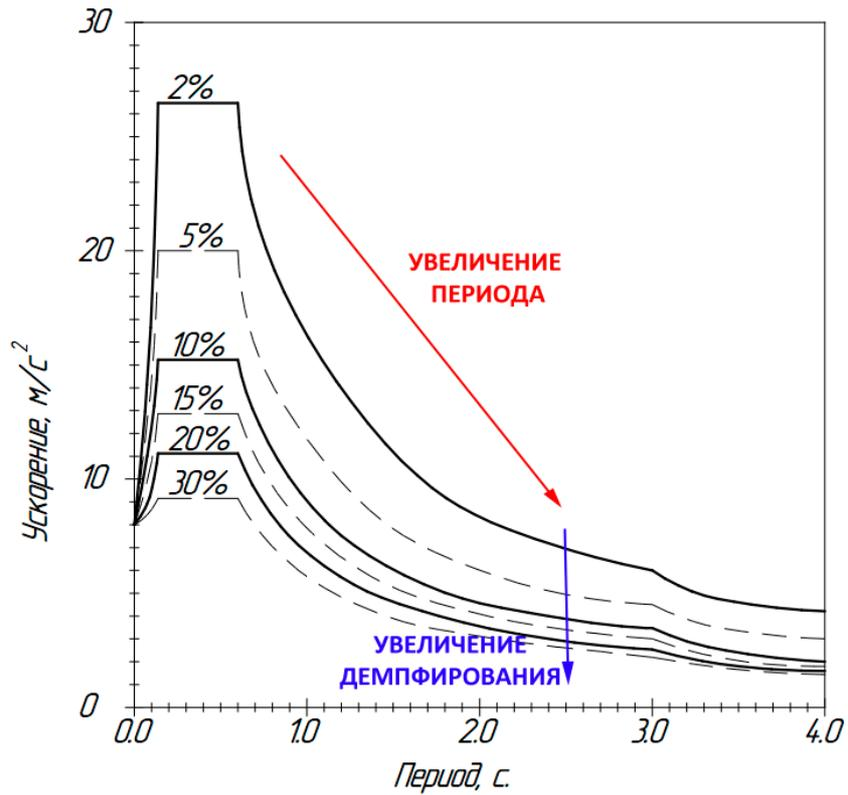
Рис. 3 - Зависимость ускорения от коэффициента демпфирования.
